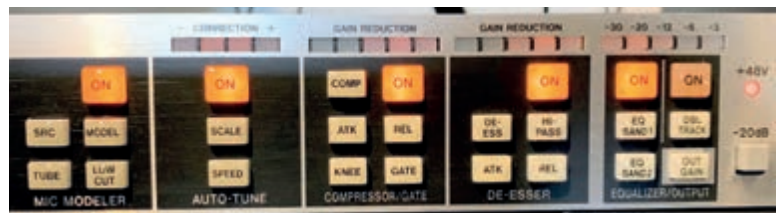
Die einzelnen Module des TA-1VP im Überblick: Die Anordnung von links nach rechts entspricht dem Signalfloss
